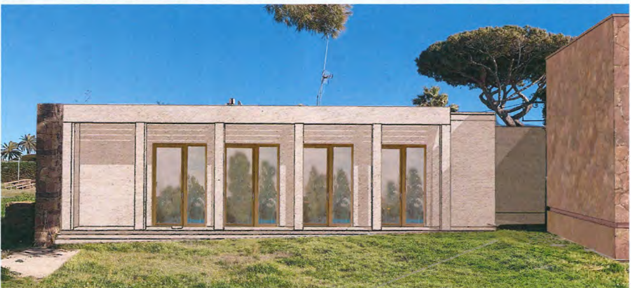
Sud, Parcelle EI099: Vu de l'implantation du futur espace de médiation en limite parcellaire, et réhausse du mur mitoyen en alignement avec les chapiteaux des piliers briques conservés.
