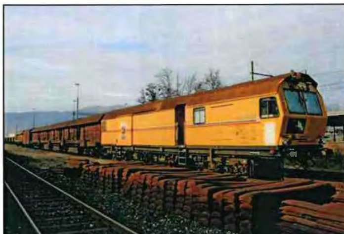
Train meuleur de rails (Scheuchzer S.A.)
